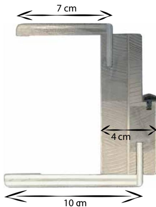
Il telaio è realizzato in listellare di abete impiallacciato nell'essenza dichiarata, completo di guarnizione di battuta in gomma. I coprifili sono invece realizzati in compensato di pioppo impiallacciati nell'essenza dichiarata con aletta mm 20 ad incastro telescopico. Nella versione Simply i coprifili esterni ed interni risultano in rilievo sul telaio.
